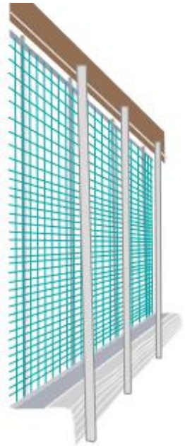
Verhoseinien verkottaminen pitää linnut poissa navetasta.
